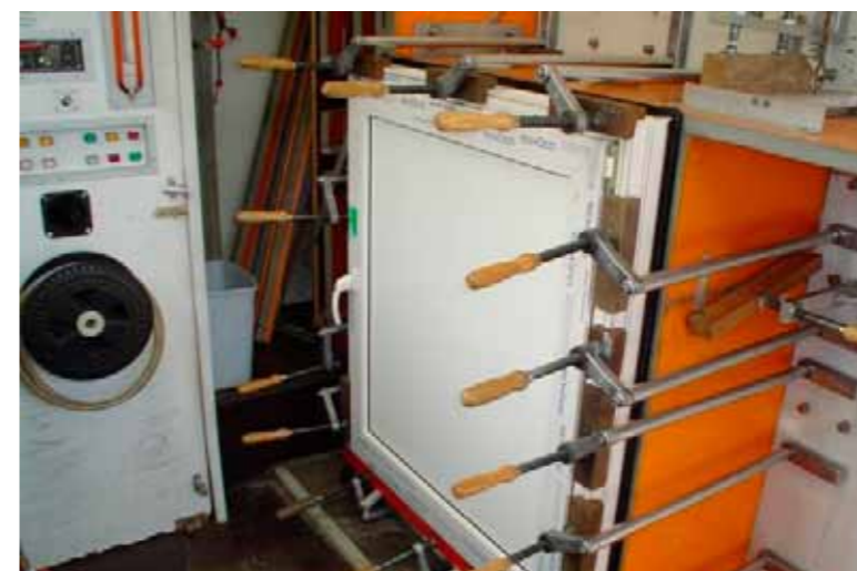
Beproeving van een kozijn in de meetwagen
