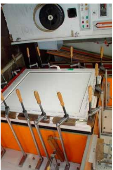
Beproeving van een kozijn in de meelwagen
