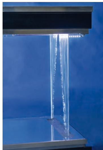
Bij de ontwikkeling van het prototype is onder andere onderzocht hoe de vloeistoffilm zich kan openen op het moment dat de gevel benaderd wordt.
