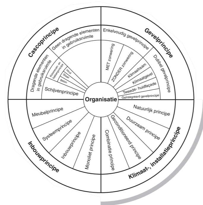
Figuur 6: Keuzecirkel klimaat-, installatieprincipe
