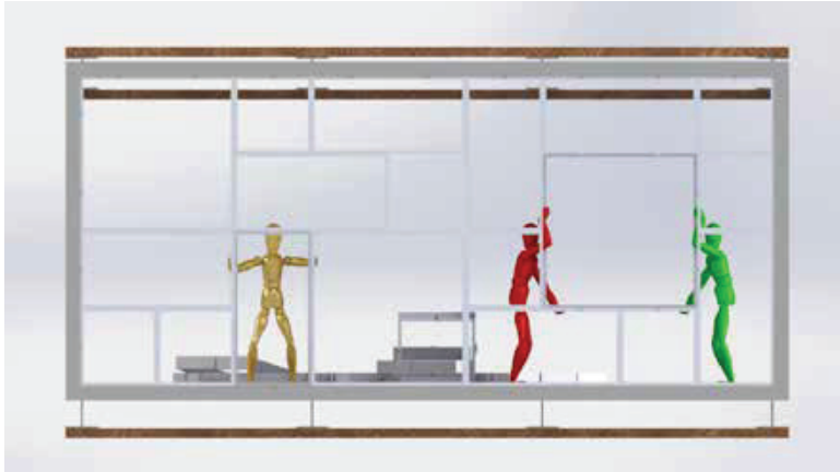
Een buitenaanzicht van de CIG met de flexibel te plaatsen gevelinvullingen.
